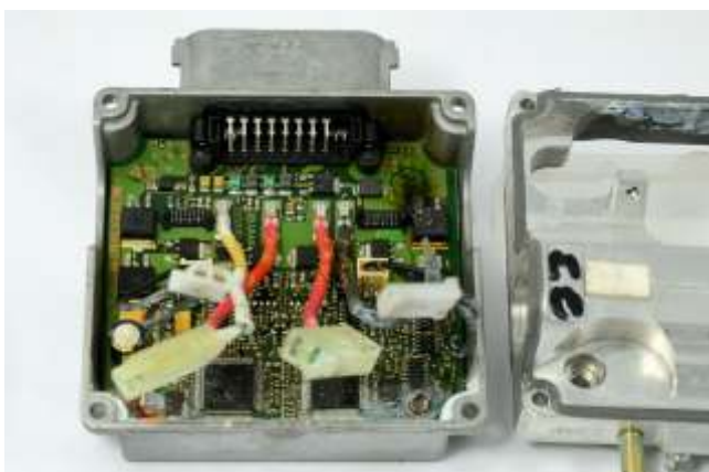
Abbildung 7 Wasserschaden und Brandschaden in CAN Gerät
