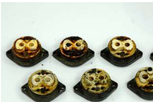
Abbildung 13 Keramikpumpen mit Korrosionsschäden
