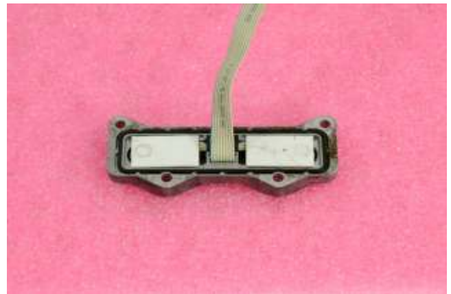
Abbildung 16 Drucksensorplatte mit Unterwanderung von Bremsflüssigkeit, gut erkennbar sind die zu kleinen Sensorflächen (Ringe)
