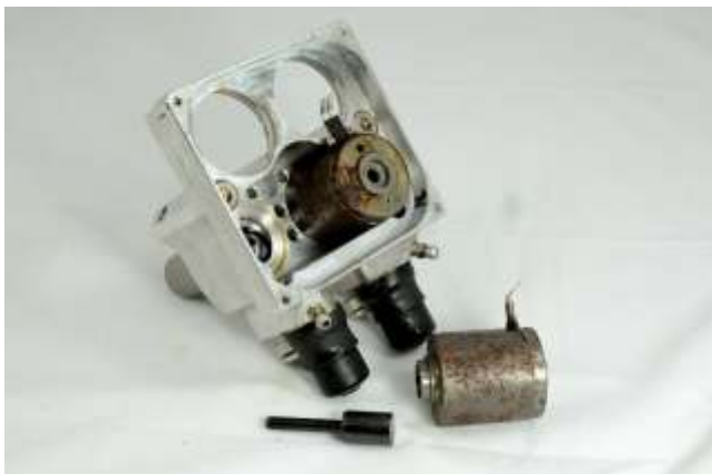
Abbildung 1 Kugelventile und ABS Kolben mit Rostansatz
