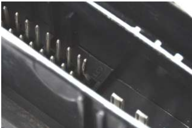
Abbildung 5 Gerätestecker (Analog Modelle) mit defektem Pin
