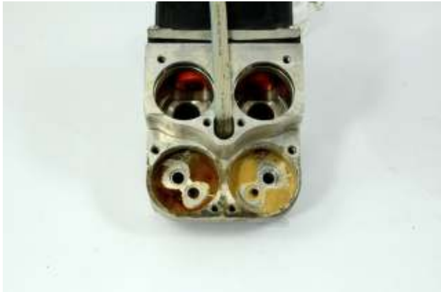
Abbildung 3 Grundgehäuse mit Pumpensitz Rost und Korrosion
