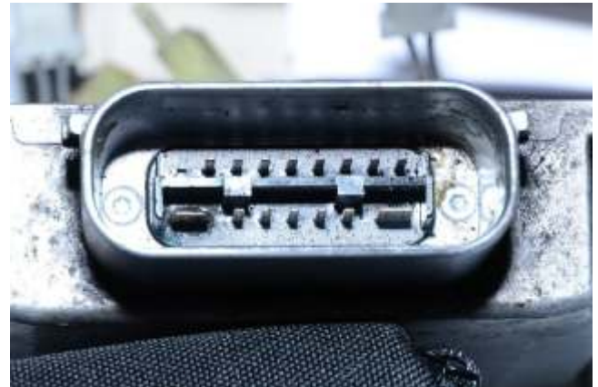
Abbildung 4 Gerätestecker (CAN Modelle) mit Wasserschaden
