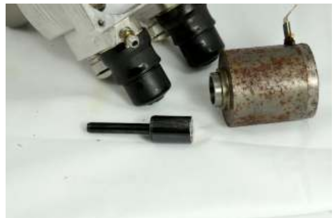
Abbildung 2 Klemmender ABS Kolben
