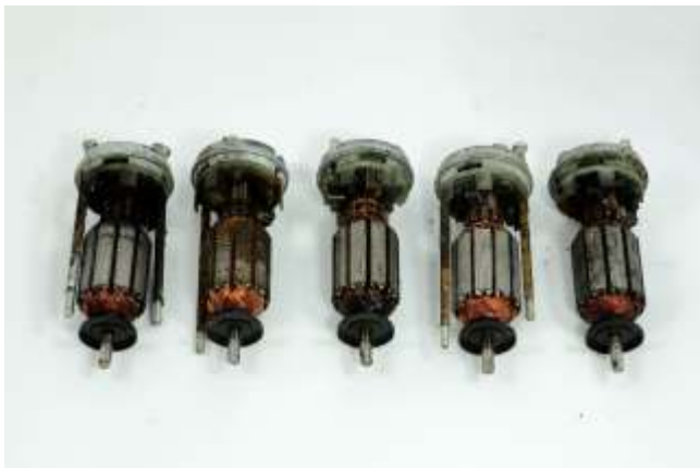
Abbildung 11 Pumpenmotoren mit Wasser, Brand und Verschleiß Schäden
