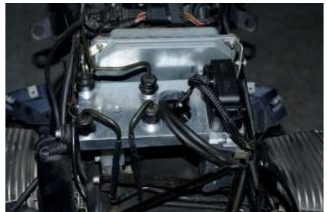
Abbildung 18 Eingebauter RH Second Life Kit ( Analog Version )
