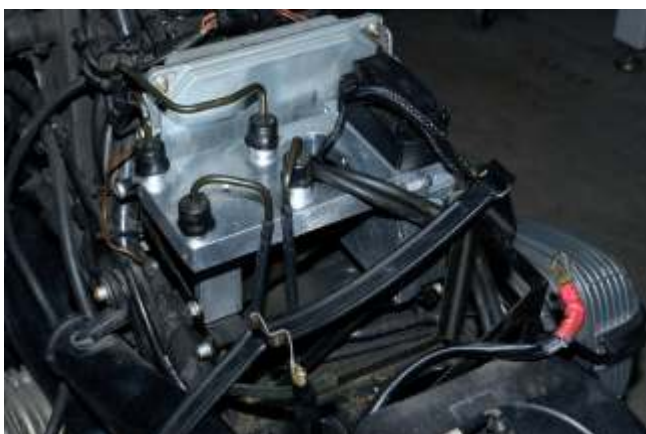
Abbildung 19 Eingebauter RH Second Life Kit (Analog Version)
