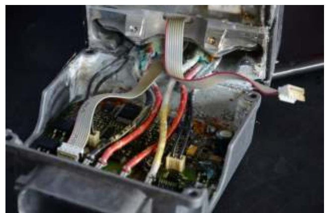
Abbildung 8 Wasserschaden im CAN Gerät
