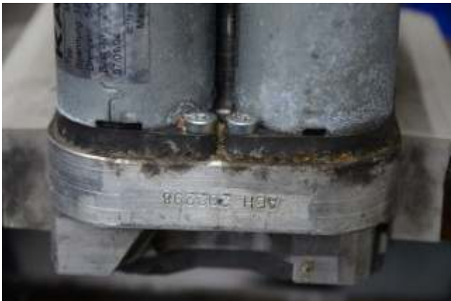
Abbildung 15 Durch Korrosion unterwanderte Keramikpumpen
