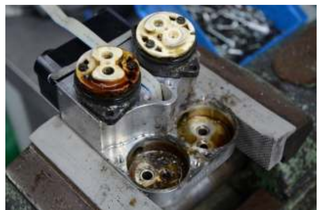
Abbildung 14 Keramikpumpen mit Korrosionsschäden im Gehäuse
