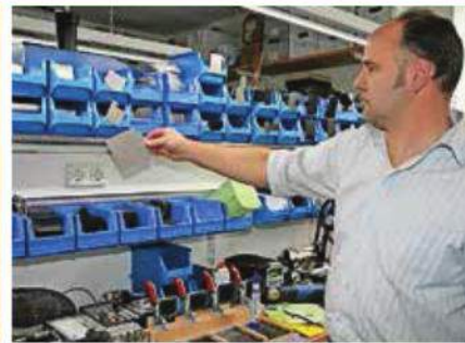
Rainer Hutterer zeigt hier, wie die Geräte wieder absolut perfekt abgedichtet werden und ein optisch ansprechendes Gehäuse erhalten. Zusätzlich werden bei einigen Typen „Atmungsmembranen“ eingesetzt, um thermischen Stress und Undichtigkeiten zu vermeiden.
