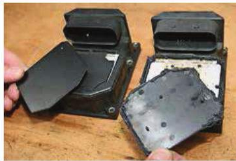
Links hui: hier wird nach der erfolgreichen Reparatur das Gerät mit speziell angefertigten Deckeln wieder verklebt. Rechts pfui: Bei dieser wenig eleganten „Bastellösung“ wurde das Gerät mit irgendeiner Dichtmasse oder Silikon zugeklebt.
