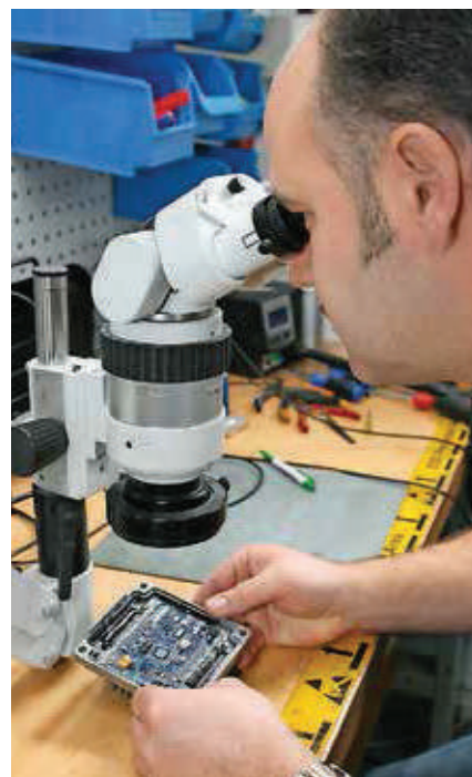
Bei der Überprüfung der Fehlerbilder werden bei der Steuergeräte-Reparatur Maßnahmen ergriffen, um die Funktionsfähigkeit wieder herzustellen. Fotos: Rinn >
