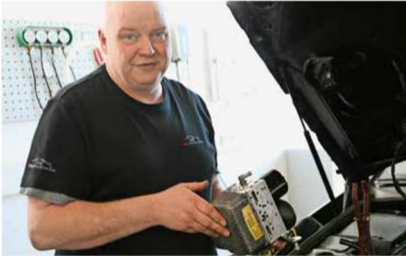
Reparatur der SBC-Bremse direkt vor Ort. FOTOS: RINN
