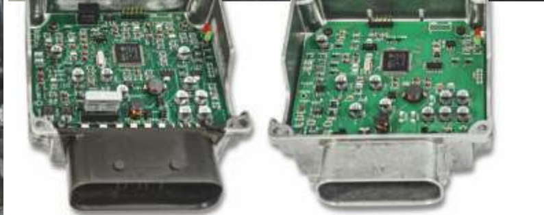
Links der Druckmodulator von FTE, also das Integral-ABS der ersten Generation (4200 Gramm). Rechts das Second-Life-Modul von RH Electronics (1200 Gramm). Unten links die Platine für die ältere, analoge Bordelektrik – wie hier. Unten rechts die Platine für jüngere CAN-Bus-Typen
